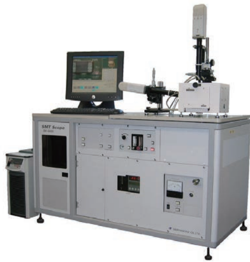
写真3 高温観察装置「SMT Scope SK-5000」
