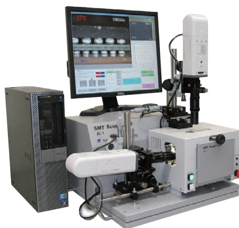
写真6 高温観察装置「SMT Scope Light SL-1」
