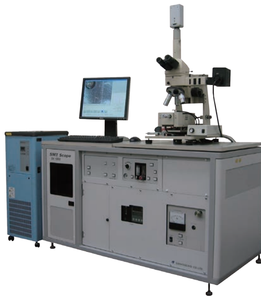
写真5 高温観察装置「SMT Scope SK-1200」
